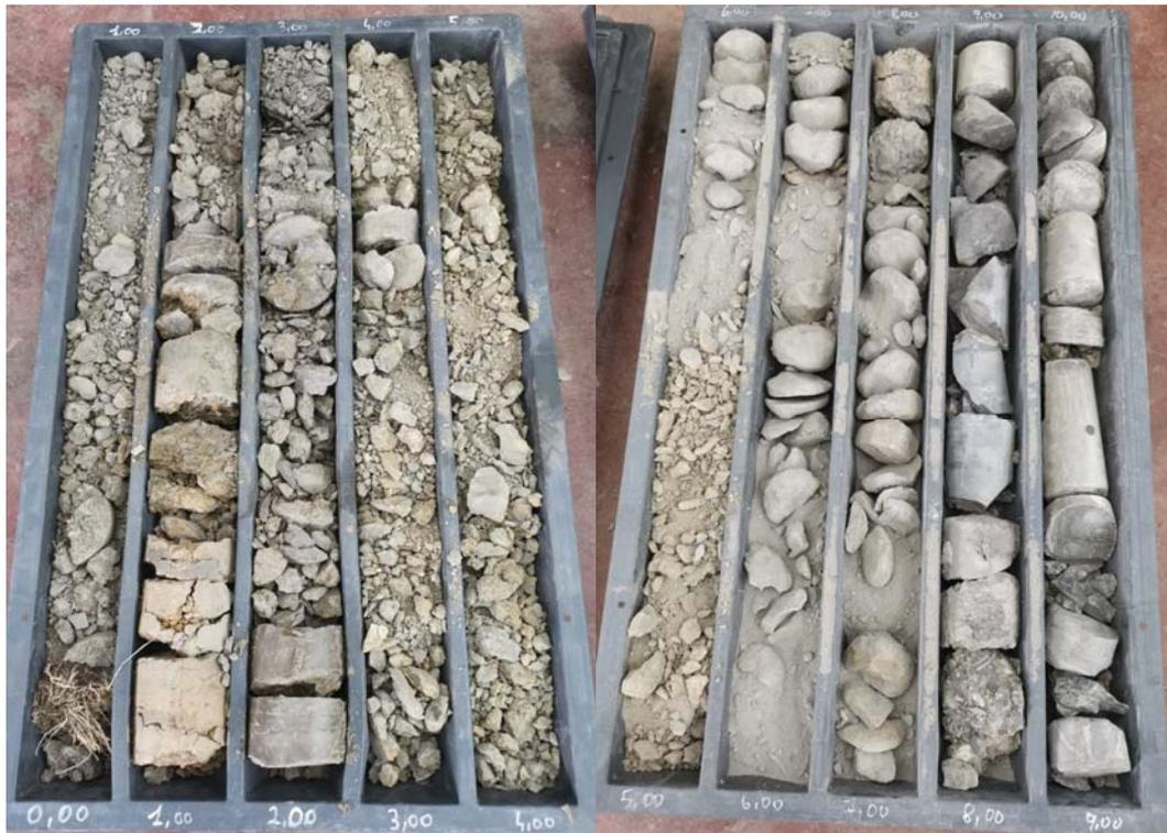
**Foto 2** – Casette catalogatrici con le carote prelevate in S1
