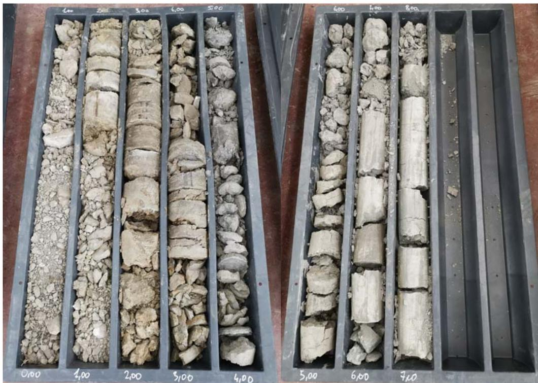
**Foto 3** – Casette catalogatrici con le carote prelevate in S2
